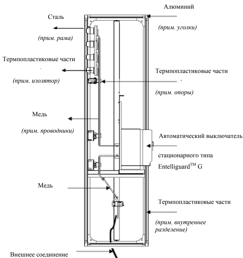
Рис.1. Стойка (600x600x2200 мм) с четырехполюсным стационарным автоматическим выключателем Entelliguard™ G на 1000А – 50кА.
